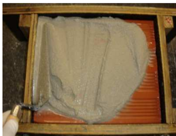
Fig. 5.33 - Espalhamento da argamassa
