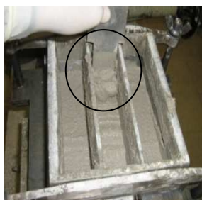
Fig. 5.27 - Regularização da 1ª camada
