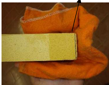
Fig. 5.65 - Remoção da água em excesso com pano húmido
