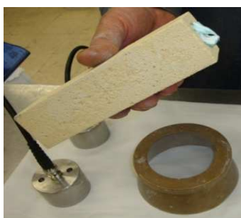
Fig. 5.43 - Colocação de massa de contacto
