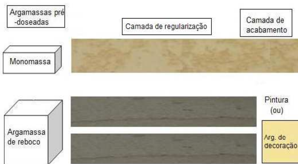
Fig. 4.6 - Esquema do número de camadas
