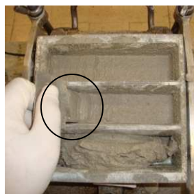
Fig. 5.28 - Regularização da 2ª camada
