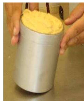
Fig. 5.17 - Compactação 2ª camada
