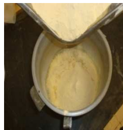
Fig. 5.13 - Adição de argamassa seca após a colocação da água
