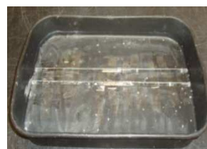
Fig. 5.63 - Tabuleiro metálico com varetas de vidro posicionadas
