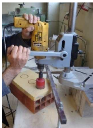
Fig. 5.51 - Execução das furações nos tijolos
