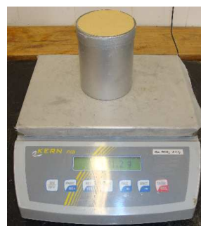
Fig. 5.19 - Pesagem do conjunto copo e argamassa
