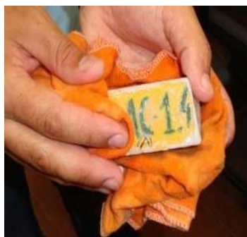
Fig. 5.71 - Remoção da água superficial
