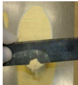
Fig. 5.9 - Rasamento pela boca do recipiente
