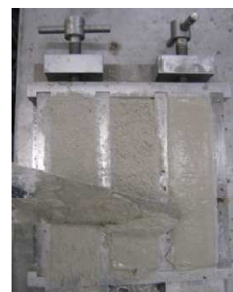
Fig. 5.29 - Regularização da argamassa em excesso
